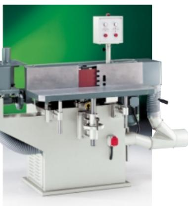
*Mehrzweck-Kantenschleifmaschine Mod. LBK, mit oszillierendem Schleifband. Ein weiterer Vorzug liegt sodann in der besonderen, über die ganze Länge wirkenden Oszillation des Schleifbandes, wodurch sich eine optimale Ausnutzung des Kornbelages und ein hervorragendes Schleifbild erreichen lassen.*
